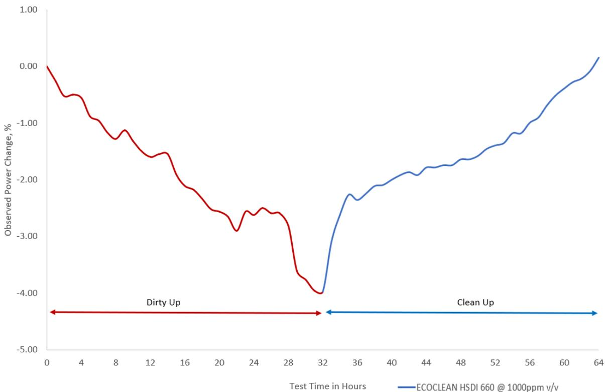
Die Grafik zeigt, dass ECOCLEAN™ HSDI 660 bei einer empfohlenen Dosierrate von 1.000ppm v/v sicher 100 % der Leistung wiederherstellt.
